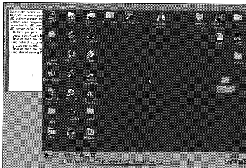
Figura 5. En esta otra, podemos ver un cliente de VNC siendo ejecutado bajo GNU/Linux, y accediendo a un servidor Windows (en realidad, el cliente de VNC de Linux está siendo controlado desde otro cliente de VNC que está corriendo sobre OS X).
